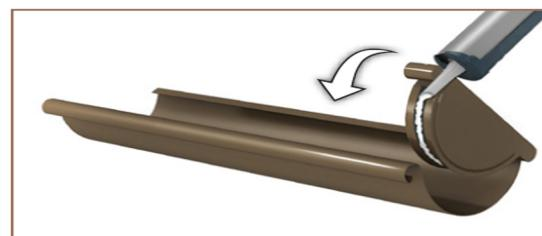
**8.** Монтаж на тапа за улук – Нанесете битумен уплътнител по уплътнението на тапата. Вмъкнете задната част на фитинга във вътрешния ръб на улuka. Завъртете задната част на тапата надолу докато прилепне плътно във улuka.
