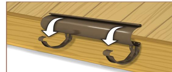
**3.** Монтаж на улук в скоба – вмъкнете вътрешния ръб на улuka в задната част на скобата. Натиснете улuka надолу докато външният му ръб щракне в предната част на скобата за улук.
