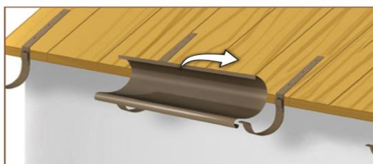
**5.** Монтаж на улук в скоба с рамо – вмъкнете предната част на скобата с рамо във външния ръб на улuka. Притиснете задния ръб на улuka пътно към задната част на скобата и фиксирайте, угъвайки пластината.
