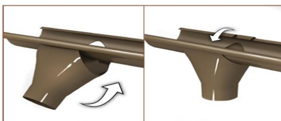
**7.** Монтаж на водосборно казанче – вмъкнете предната част на фитинга във външния ръб на улuka. Завъртете задната част на фитинга нагоре докато прилепне плътно в улук. Огънете двете пластини на водосборното казанче плътно в улук.
