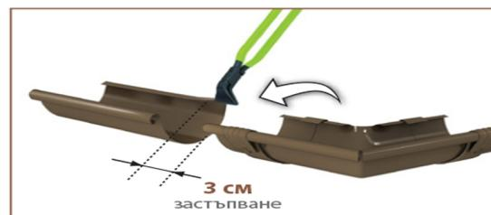
**11.** Снаждане на улук и ъгъл – отворете вътрешния ръб на улuka нагоре, с 3 см по дължина. Вмъкнете предната част на ъгъла във външния ръб на улuka. Завъртете задната част на ъгъла нагоре докато прилепне в улuka. Огънете вътрешния ръб на улuka върху ъгъла. Монтирайте снадката за улук върху застъпената площ.
