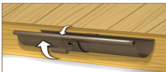
**10.** Монтаж на снадка за улук – закачете задната част на снадката върху вътрешните ръбове на елементите, които искате да свържете. Завъртете предната част на фитинга нагоре и заключете. Фиксирайте с помощта на контриращата пластина.
