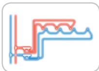
Сериен монтаж, като се използват тройни адаптори
