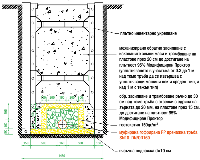
Типов напречен профил М 1:25
