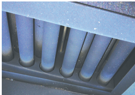
схема 7. Почистване на пепелта от димогарните тръби
