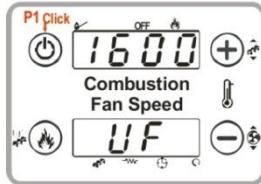
**UF**= Скорост на вентилатора [RPM/Volt]]
