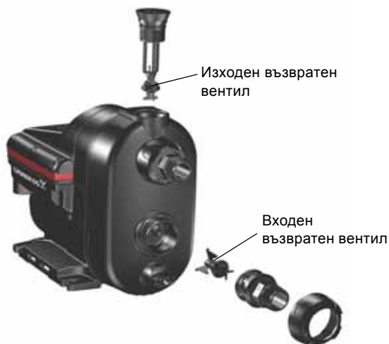
Фиг. 21 Входен и изходен възвратни вентили
