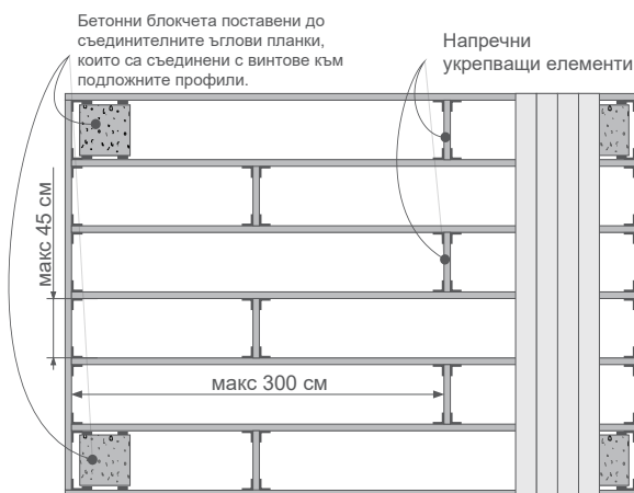
„Плаваща“ тераса – конструкция (рама) от подложни профили, съединени с ъгливи планки и с поставени бетонни блокчета
